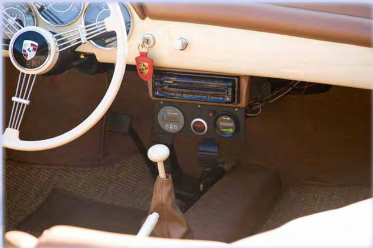
图一：‘Speedster Part Duh’ 内部， BMV-600HS 安装在仪表板上。
